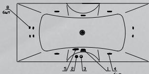
**DeLuxe:** комплект гидромассажа (6 форсунок) и комплект аэромассажа (10 форсунок)
