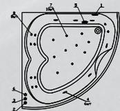
**Elite:** комплект гидромассажа (6 форсунок), комплект аэромассажа (10 форсунок), комплект спинного массажа (6/8/10 миниджет) и хромотерапия
