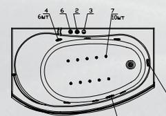
**DeLuxe+:** комплект гидромассажа (6 форсунок), комплект аэромассажа (10 форсунок) и комплект спинного массажа (6/8/10 миниджет)
