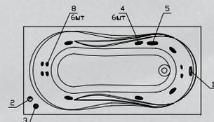
**DeLuxe:** комплект гидромассажа (6 форсунок) и комплект аэромассажа (10 форсунок)
