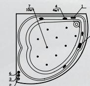
**DeLuxe+:** комплект гидромассажа (6 форсунок), комплект аэромассажа (10 форсунок) и комплект спинного массажа (6/8/10 миниджет)
