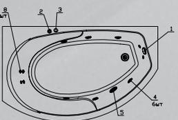
**DeLuxe:** комплект гидромассажа (6 форсунок) и комплект аэромассажа (10 форсунок)
