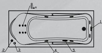
**DeLuxe:** комплект гидромассажа (6 форсунок) и комплект аэромассажа (10 форсунок)
