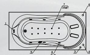
**DeLuxe+:** комплект гидромассажа (6 форсунок), комплект аэромассажа (10 форсунок) и комплект спинного массажа (6/8/10 миниджет)
