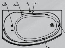
**DeLuxe:** комплект гидромассажа (6 форсунок) и комплект аэромассажа (10 форсунок)
