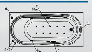
**DeLuxe+:** комплект гидромассажа (6 форсунок), комплект аэромассажа (10 форсунок) и комплект спинного массажа (6/8/10 миниджет)
