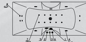
**Elite:** комплект гидромассажа (6 форсунок), комплект аэромассажа (10 форсунок), комплект спинного массажа (6/8/10 миниджет) и хромотерапия
