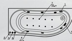
**DeLuxe+:** комплект гидромассажа (6 форсунок), комплект аэромассажа (10 форсунок) и комплект спинного массажа (6/8/10 мини-иджет)
