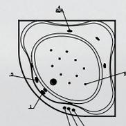
**DeLuxe+:** комплект гидромассажа (6 форсунок), комплект аэромассажа (10 форсунок) и комплект спинного массажа (6/8/10 миниджет)
