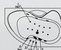
**DeLuxe+:** комплект гидромассажа (6 форсунок), комплект аэромассажа (10 форсунок) и комплект спинного массажа (6/8/10 миниджет)
