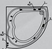
**DeLuxe:** комплект гидромассажа (6 форсунок) и комплект аэромассажа (10 форсунок)
