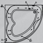
**DeLuxe:** комплект гидромассажа (6 форсунок) и комплект аэромассажа (10 форсунок)
