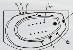
**DeLuxe+:** комплект гидромассажа (6 форсунок), комплект аэромассажа (10 форсунок) и комплект спинного массажа (6/8/10 миниджет)
