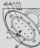
**Elite:** комплект гидромассажа (6 форсунок), комплект аэромассажа (10 форсунок), комплект спинного массажа (6/8/10 миниджет) и хромотерапия
