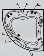
**DeLuxe:** комплект гидромассажа (6 форсунок) и комплект аэромассажа (10 форсунок)
