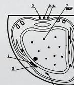
**DeLuxe+:** комплект гидромассажа (6 форсунок), комплект аэромассажа (10 форсунок) и комплект спинного массажа (6/8/10 миниджет)
