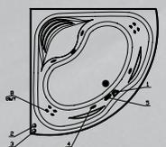
**DeLuxe:** комплект гидромассажа (6 форсунок) и комплект аэромассажа (10 форсунок)
