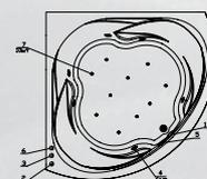
**DeLuxe+:** комплект гидромассажа (6 форсунок), комплект аэромассажа (10 форсунок) и комплект спинного массажа (6/8/10 миниджет)
