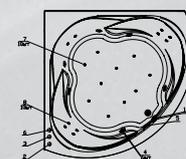
**Elite:** комплект гидромассажа (6 форсунок), комплект аэромассажа (10 форсунок), комплект спинного массажа (6/8/10 миниджет) и хромотерапия
