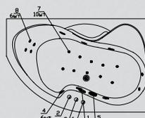
**Elite:** комплект гидромассажа (6 форсунок), комплект аэромассажа (10 форсунок), комплект спинного массажа (6/8/10 миниджет) и хромотерапия
