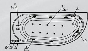
**Elite:** комплект гидромассажа (6 форсунок), комплект аэромассажа (10 форсунок), комплект спинного массажа (6/8/10 мини-иджет) и хромотерапия
