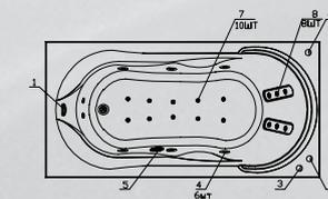
**Elite:** комплект гидромассажа (6 форсунок), комплект аэромассажа (10 форсунок), комплект спинного массажа (6/8/10 миниджет) и хромотерапия
