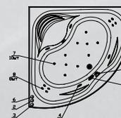
**Elite:** комплект гидромассажа (6 форсунок), комплект аэромассажа (10 форсунок), комплект спинного массажа (6/8/10 миниджет) и хромотерапия
