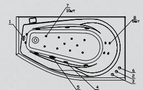
**Elite:** комплект гидромассажа (6 форсунок), комплект аэромассажа (10 форсунок), комплект спинного массажа (6/8/10 миниджет) и хромотерапия
