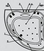
**Elite:** комплект гидромассажа (6 форсунок), комплект аэромассажа (10 форсунок), комплект спинного массажа (6/8/10 миниджет) и хромотерапия
