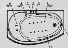
**Elite:** комплект гидромассажа (6 форсунок), комплект аэромассажа (10 форсунок), комплект спинного массажа (6/8/10 миниджет) и хромотерапия
