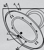
**DeLuxe:** комплект гидромассажа (6 форсунок) и комплект аэромассажа (10 форсунок)
