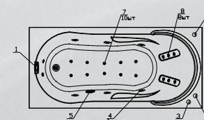
**Elite:** комплект гидромассажа (6 форсунок), комплект аэромассажа (10 форсунок), комплект спинного массажа (6/8/10 миниджет) и хромотерапия
