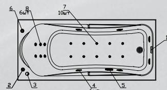
**Elite:** комплект гидромассажа (6 форсунок), комплект аэромассажа (10 форсунок), комплект спинного массажа (6/8/10 миниджет) и хромотерапия
