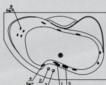
**DeLuxe:** комплект гидромассажа (6 форсунок) и комплект аэромассажа (10 форсунок)
