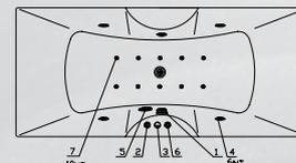
**DeLuxe+:** комплект гидромассажа (6 форсунок), комплект аэромассажа (10 форсунок) и комплект спинного массажа (6/8/10 миниджет)
