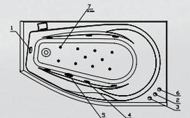
**DeLuxe+:** комплект гидромассажа (6 форсунок), комплект аэромассажа (10 форсунок) и комплект спинного массажа (6/8/10 миниджет)
