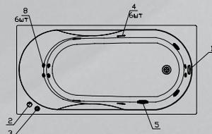
**DeLuxe:** комплект гидромассажа (6 форсунок) и комплект аэромассажа (10 форсунок)
