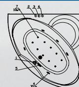
**DeLuxe+:** комплект гидромассажа (6 форсунок), комплект аэромассажа (10 форсунок) и комплект спинного массажа (6/8/10 миниджет)
