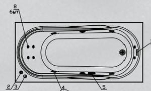
**DeLuxe:** комплект гидромассажа (6 форсунок) и комплект аэромассажа (10 форсунок)
